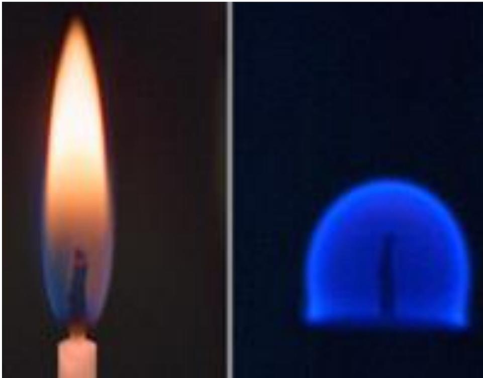
*Langsame Verbrennung mit und ohne Gravitation und Sauerstoff (aus; „science ORF“; - „Wie Flammen in der Schwerelosigkeit brennen“)*
