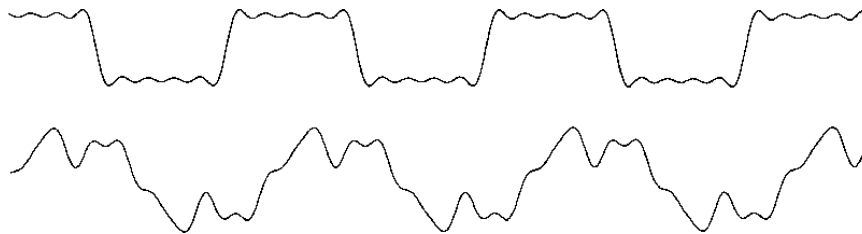
Oben: Annäherung an die rechteckige Kurve. Unten: Dieselben Partialtöne mit Phasenverschiebung
