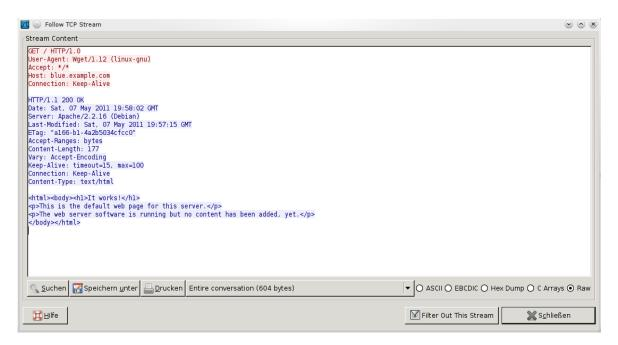
Bild 3.5: Verfolgung von TCP-Verbindungen mit wireshark
