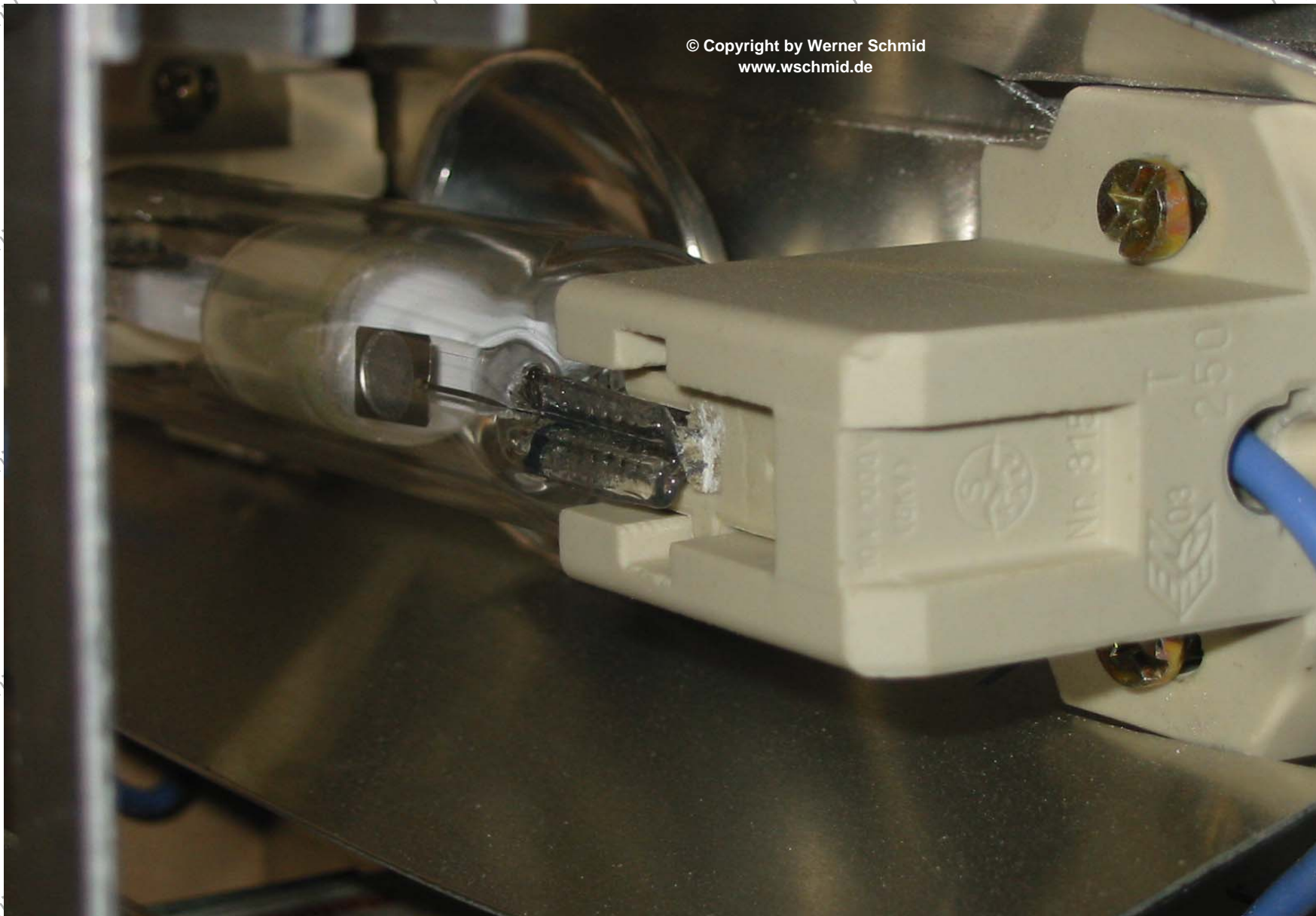
So steckt der Brenner in der Fassung
